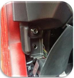
Schraube lösen und Blech (auf Bild 1) etwas vor ziehen um den Halteclip zu erreichen und zu lösen
