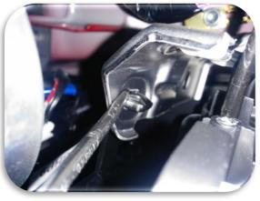
Halteclip aus Blech entfernen
