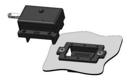
Stecken Sie das Schlosssystem auf und befestigen es mit den M3 Schrauben.
