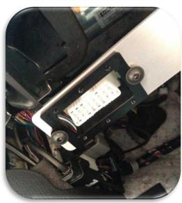
Gehäuse inkl. OBD-Buchse mit Halterahmen verschrauben
