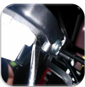
OBD-Buchse aus Halterung entfernen durch eindrücken der Rastnase
