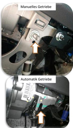
Mutter lösen und Halteblech auf Gewindespille stecken >Mutter wieder fest andrehen.
