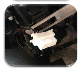
OBD-Buchse durch die Öffnung des Haltebleches stecken
