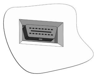
original OBD Buchse aus Verkleidung lösen. Halteclip vom OBD-Buchsenkabel öffnen bzw. entfernen um benötigte Kabellänge zu erhalten
