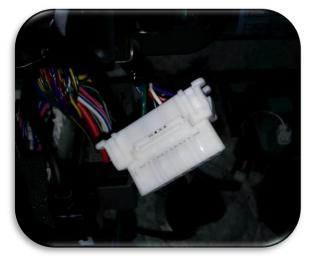
Kunststoffsteg an OBD-Buchse entfernen
